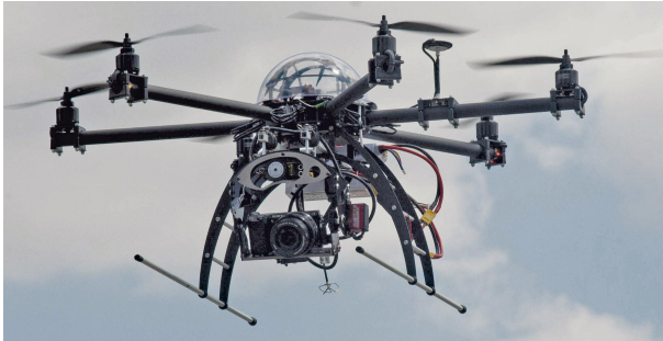
Drohne für Luftaufnahmen und zur Thermografie-Messung
